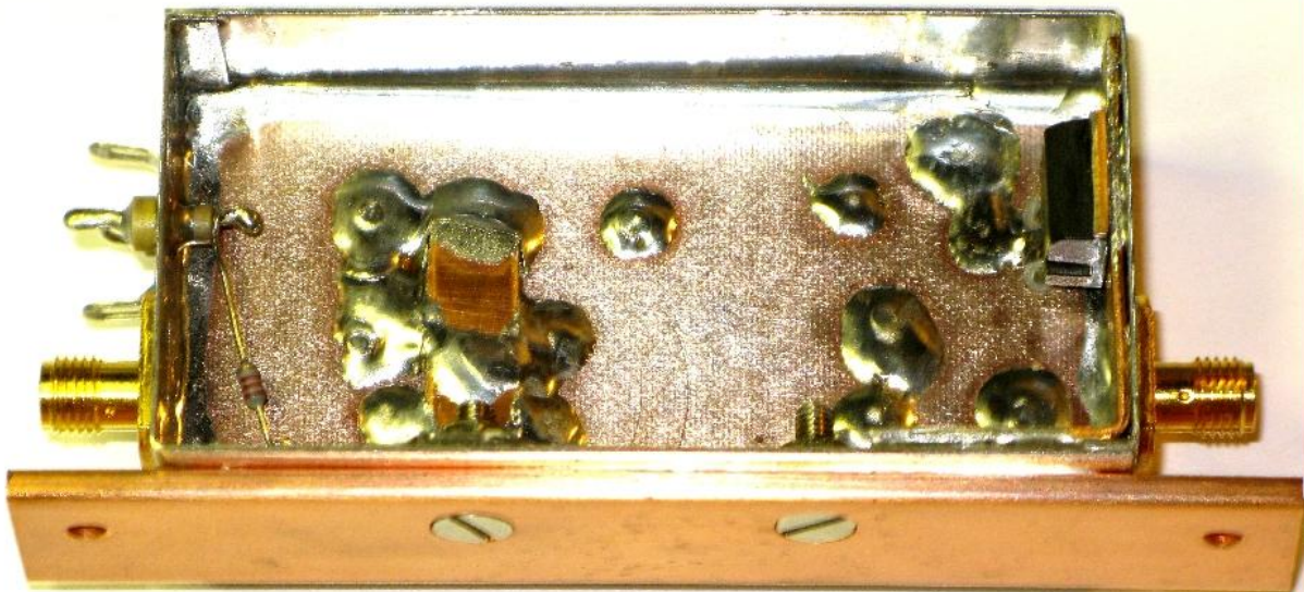
Fig. 6b - Vista dal lato massa del terzo esemplare. La barra di rame è vincolata con viti in corrispondenza delle bandelle rame saldate a massa ed alla parete laterale del contenitore, per un'efficiente trasporto del calore.
